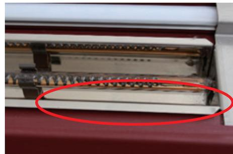
加热管外单层设计，隔热靠机壳内隔热棉，隔热棉的不均匀会影响隔热效果。
