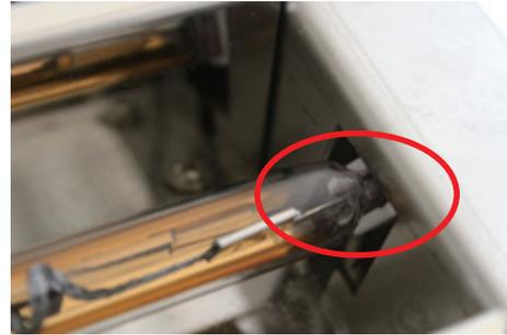
碳纤维加热管。加热管与机壳安装处细管十分脆弱，容易损坏造成安全隐患。
